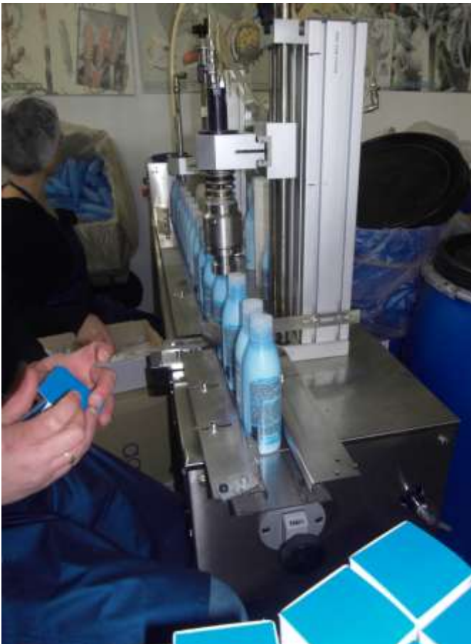
Reparto confezionamento ( in alto ) e Macchine riempitrici per liquidi e fiale di vetro ( in basso )
